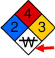
Şekil : Su ile reaktif kimyasalların NFPA etiketinde gösterilmesi
